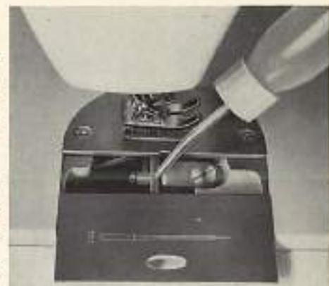
Ölstelle ist rot markiert.
